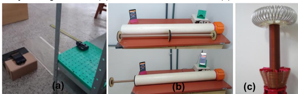
Figura 2 – Alguns dos produtos feitos pelo laboratório Ciência 3D Impressa para o ensino de Física. (a) Canhão de Gauss para a determinação da aceleração da gravidade. (b) Tubo de ondas sonoras. (c) Bobina de Tesla
