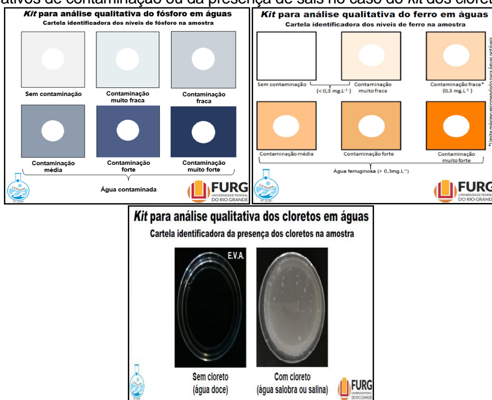
Figura 2 – Cartelas de cores identificadoras dos níveis de contaminação das amostras analisadas com os kits analíticos. Cada tonalidade identifica um dos níveis gradativos de contaminação ou da presença de sais no caso do kit dos cloretos
